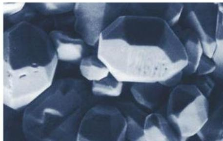
Sulfatierte Batterieplatte (Inaktiv)
